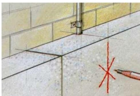
Рисунок 13.1 – Устройство разметки в местах прокладки инженерных сетей
