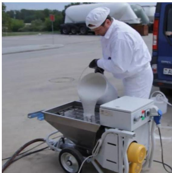
Рисунок 21 - Заполнение бункера штукатурного агрегата
