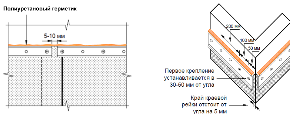
Рисунок 19 – Установка краевой рейки на углу
